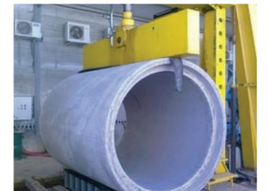
En los tubos de hormigón, al residir en ellos prácticamente la totalidad de la capacidad resistente del sistema, se aprovechan todas las ventajas de la prefabricación: procesos automatizados, estrictos controles de calidad... Se garantiza así una alta calidad, no sólo en la propia tubería, sino en el conjunto de la instalación.
