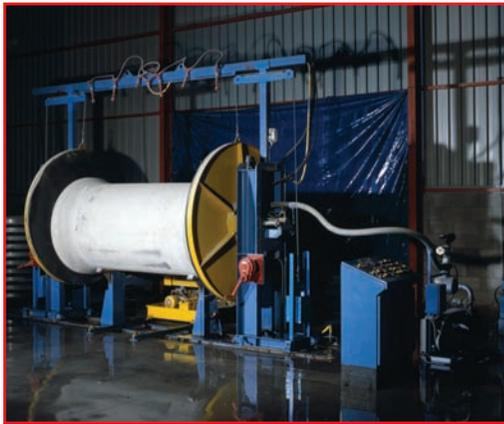
incorrecta instalación. De acuerdo a los requisitos establecidos en el Anexo ZA de la Norma UNE-EN 1916 en todas las fábricas de tubos de hormigón se somete a un control estadístico de la estanquidad de las juntas, así como la estanquidad de los propios tubos. La propia junta es también sometida a ensayos que garanticen su correcto funcionamiento a largo plazo.
