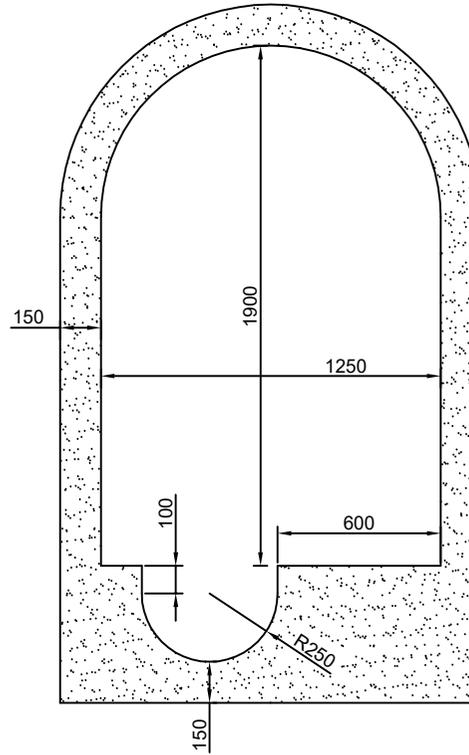
GALERÍA ABOVEDADA MACHIHEMBRADA CON CUNA SEMICIRCULAR TIPO II - AM
