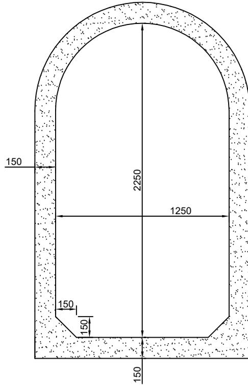
GALERÍA ABOVEDADA MACHIHEMBRADA SIN ANDÉN TIPO II - AM
